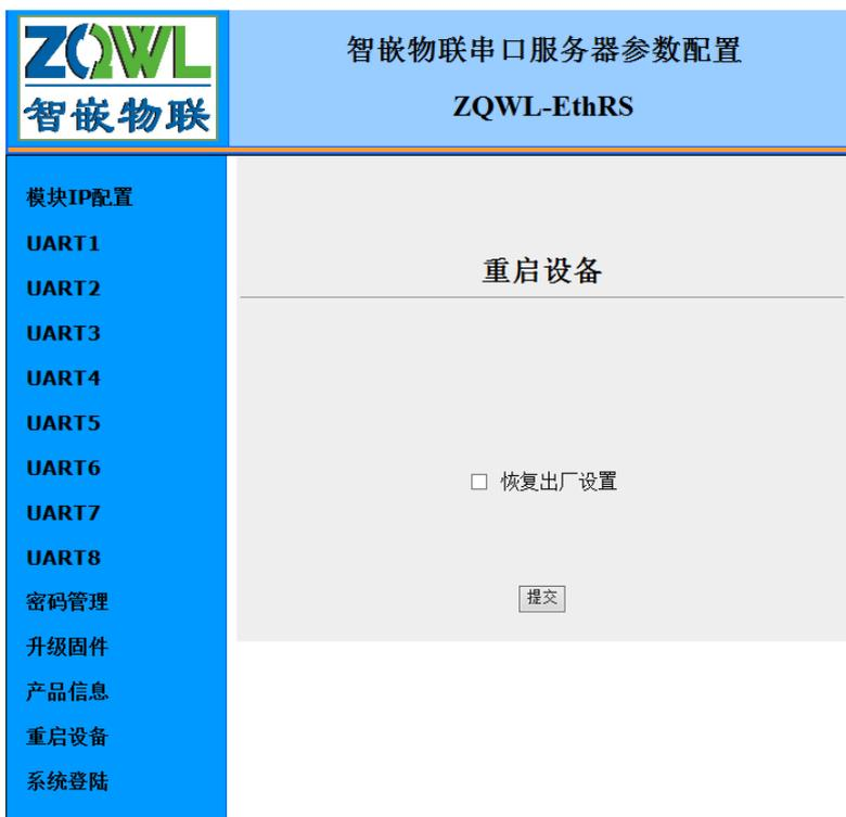
如上图，在“重启设备”页面中，可以对设备重启，如果选中“恢复出厂设置”，则模块参数将恢复到出厂参数。
