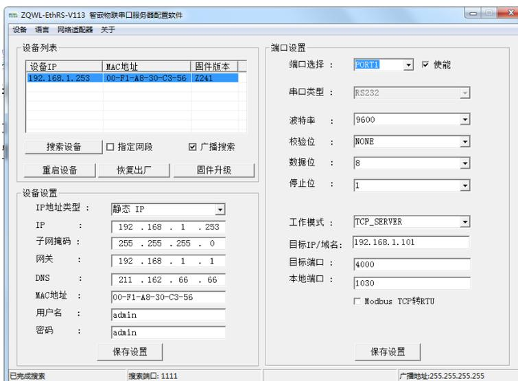
配置软件的左侧部分为 8 个端口所共有参数，右侧部分可以通过“端口选择”下拉来选择时哪个 PORT 口,从而实现 8 个端口的分别配置。
