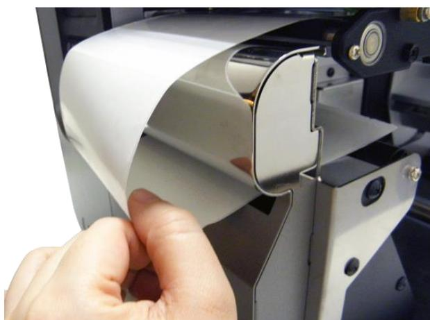
5. 開啟印字頭座架釋放桿和導紙桿釋放桿。並把標籤往出紙口拉出約 650mm 的長度。
