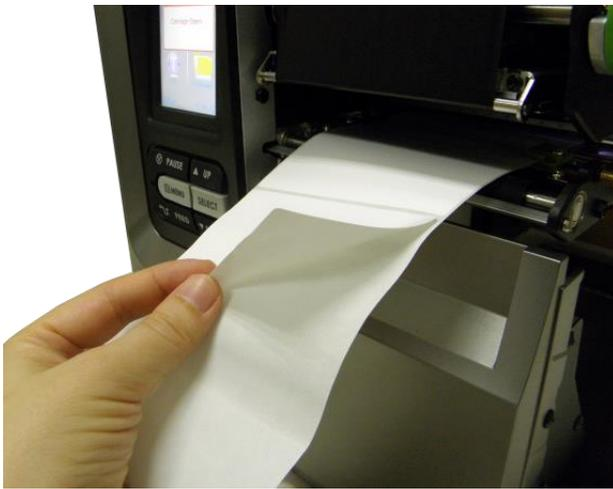
4. 開啟印字頭座架釋放桿和導紙桿釋放桿。並把標籤往出紙口拉出約 650mm 的長度。
