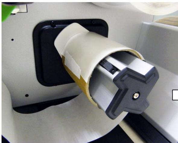
8. 將底紙平整的固定於空紙卷上，並用手逆時鐘捲動回收軸使底紙完全呈現平滑張緊狀態為止。
