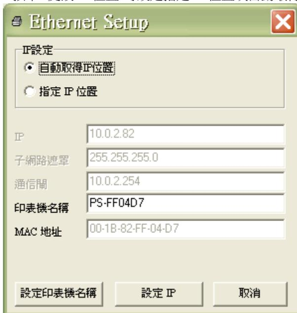
此 IP 設定的出廠預設值為“自動取得 IP 位置”。如需改變 IP 位置請選擇“指定 IP 位置”並輸入欲設定的 IP，子網路遮罩和通信閘，之後按下“設定 IP”鍵設定
