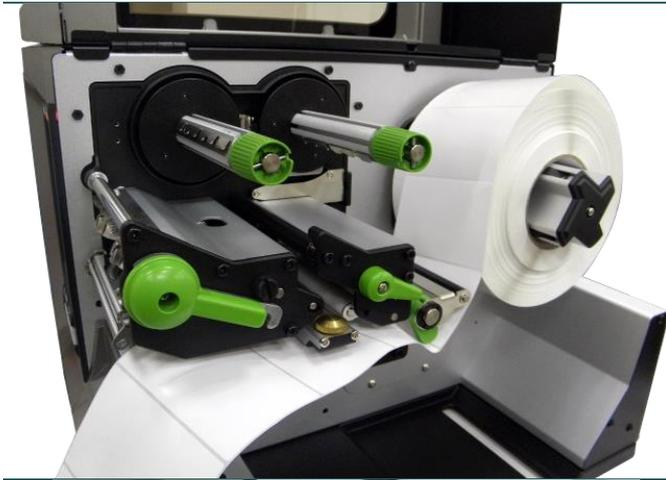
4. 使標籤紙穿過標籤導紙桿，並使標籤紙通過標籤感應器，向印字頭出口拉出到橡膠滾輪位置。
