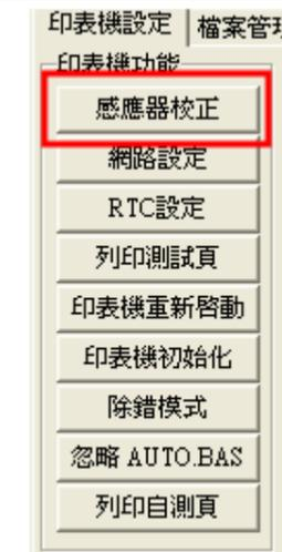
4. 選擇您紙張的類型(間隙紙/黑標紙/連續紙) 和 選擇偵測的方式 (自動/手動)。一般的情況您可直接於選擇紙張類型後按下 "紙張校正" 鍵即可自動校正您條碼機的標籤感應器。
